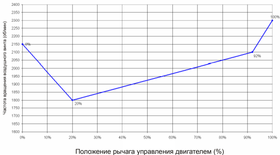
Рисунок 2. Регулирование частоты вращения воздушного винта блоком управления двигателем
