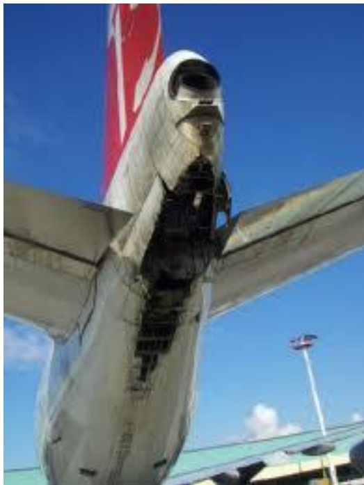
Последствия неремонтируемого удара хвостом 747 из-за перепутанных весов (ZFW&TOW)
