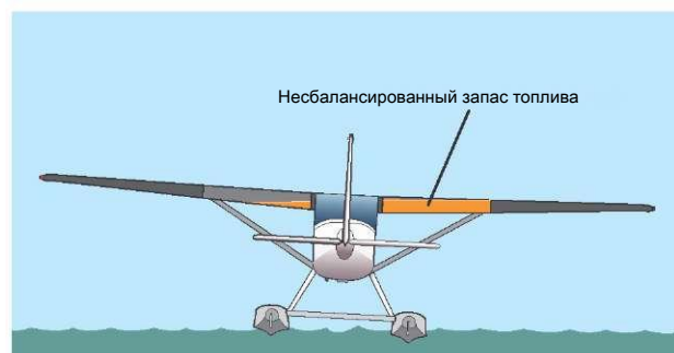
Рисунок 5-1. Расположение ЦТ влияет на поведение гидросамолета.
