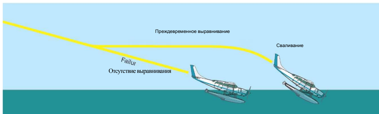
Рисунок 6-6. Последствия неправильного определения высоты над зеркальной поверхностью могут быть катастрофическими. 4-6
