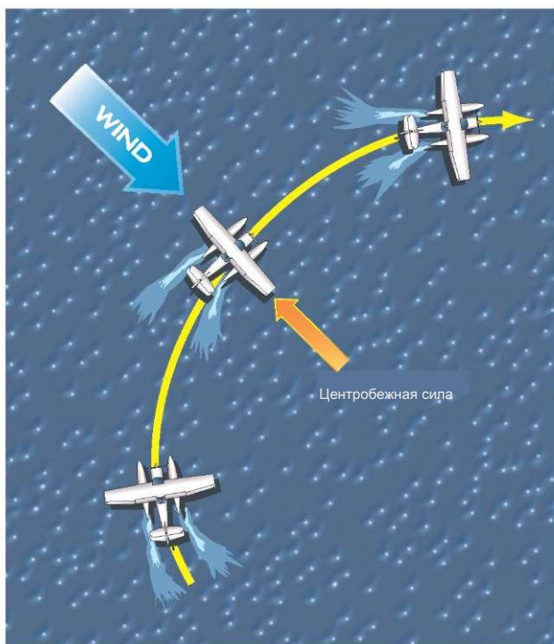
Рисунок 4-17. На подветренной дуге сила ветра уравнивается центробежной силой.
