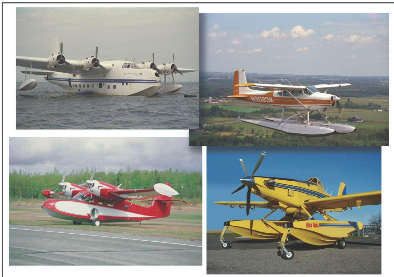
Рисунок 2-1. Летающие лодки, поплавковые гидросамолеты и амфибии.
