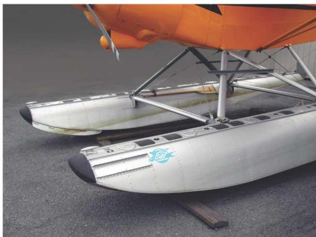
Рисунок 4-1. При предполетном осмотре гидросамолета на суше можно внимательно осмотреть поплавки ниже ватерлинии. Обратите внимание на брызгоотражатель на внутренней скуле дальнего поплавка на фотографии.
