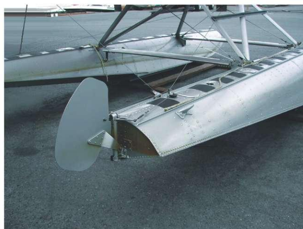
Рисунок 4-4. Проверьте работу водорулей, тросов, пружин и шкивов.
