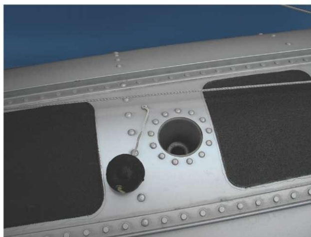
Рисунок 4-2. Отверстие для трюмного насоса закрыто мягким резиновым шариком.
