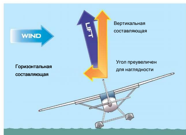
Рисунок 6-4. При опускании наветренного крыла используется горизонтальная составляющая подъемной силы, которая уравнивает снос от бокового ветра.
