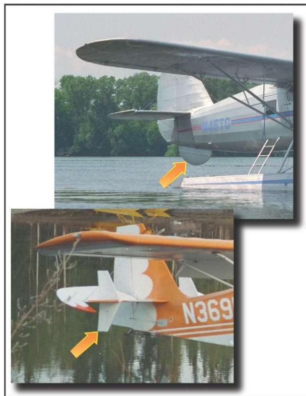
Рисунок 5-3. Дополнительные вертикальные поверхности на хвосте поплавков помогают восстановить путевую устойчивость.
