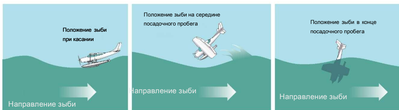
Рисунок 8-6. Посадка против зыби сокращает кажущееся расстояние между гребнями и может привести к нежелательным последствиям.
