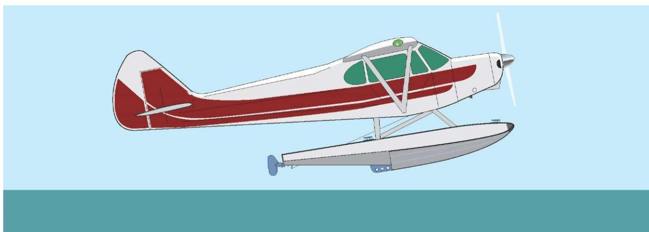
Рисунок 6-2. Тангаж при посадке для большинства гидросамолетов очень близок к углу тангажа при рулении на редане.
