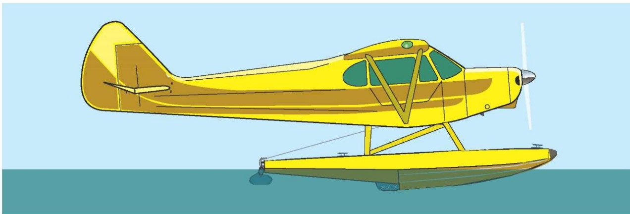
Рисунок 4-5. Режим малого газа. Двигатель работает на малых оборотах, гидросамолет медленно движется, тангаж почти горизонтальный, гидросамолет удерживается плавучестью.
