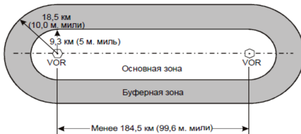
Рис. 6.4. Определение защитного воздушного пространства для участка трассы, основанной на VOR, при расстоянии между маяками менее 184,5 км (99,6 м. миль)
