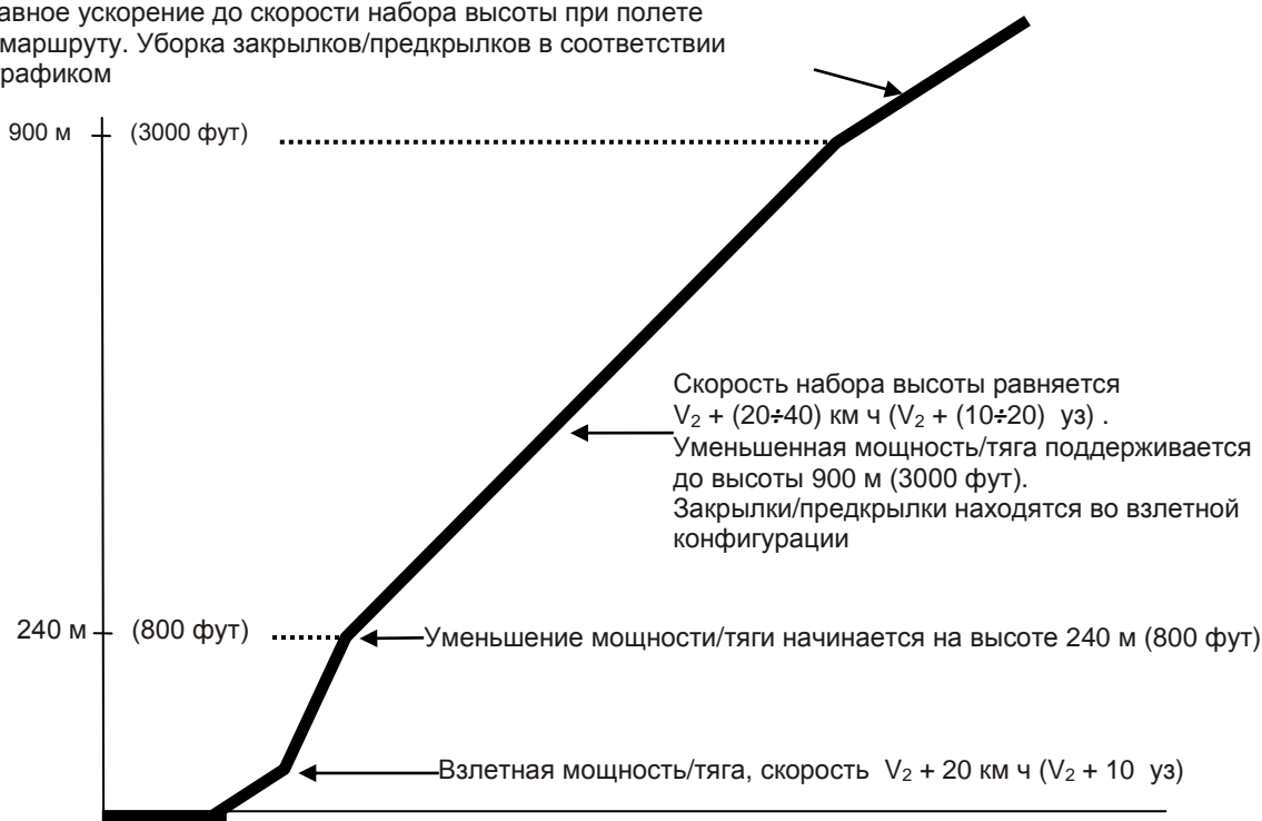
Рис. 8.35. Снижение шума при наборе высоты во время вылета. Пример метода уменьшения воздействия шума вблизи аэродрома (NADP 1)
