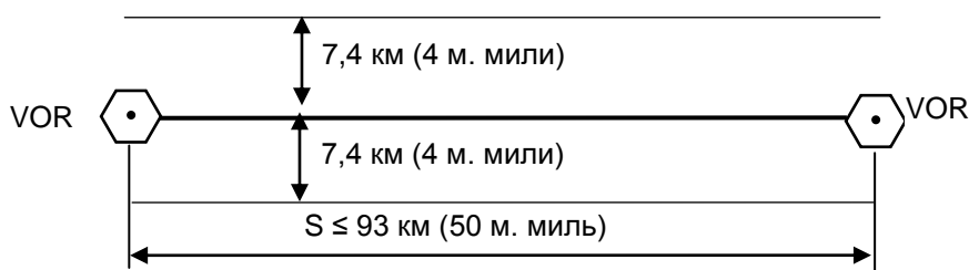
Рис. 6.1. Определение защитного воздушного пространства по Приложению 11 при расстоянии между VOR \leq 93 км (50 м. миль)
