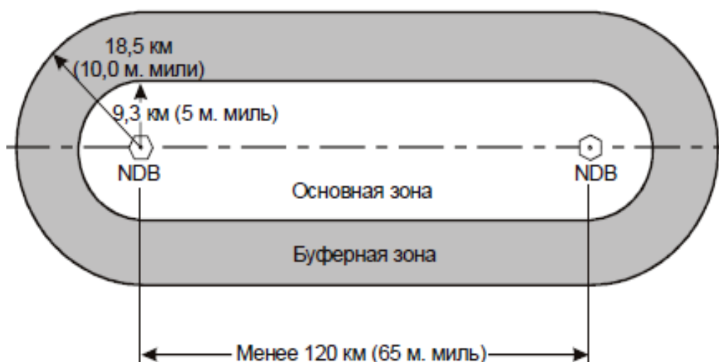
Рис. 6.6. Определение защитного воздушного пространства для участка трассы, основанной на NDB, при расстоянии между маяками менее 120 км (65 м. мили)
