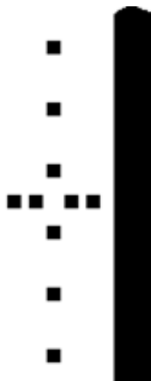
Рис. 5.20. Система визуальной индикации глиссады AT-VASI
