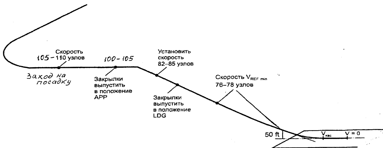
Рис. 10.1. Схема захода на посадку самолета DA 40
