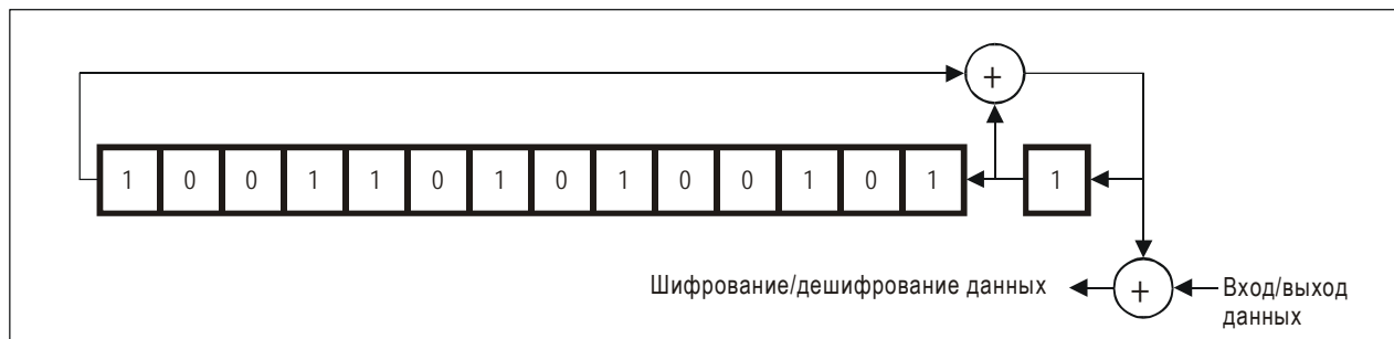
Рис. D-5. Шифратор/дешифратор битов
